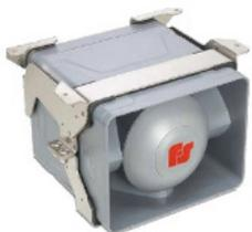
Esta bocina electrónica está diseñada para soportar entornos de alta vibración. Capaz de producir dos tonos de bocina de alto decibelio a través de la amplificación interna y los circuitos de tono. Resistente a la corrosión y a la intemperie según IP66, es adecuado para maquinaria en minería, puertos e industria pesada.
