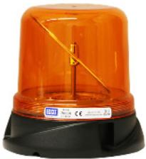
La baliza giratoria LED Gen II combina los principales beneficios de los LED con la inconfundible señal de advertencia de un rotador. Utiliza un sistema de accionamiento magnético sin escobillas para hacer girar el disco reflector, lo que reduce el ruido y elimina los inconvenientes típicos del motor/engranaje asociados con los rotores convencionales
