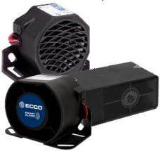
Las alarmas de respaldo multifrecuencia minimizan la contaminación acústica al emitir sonido a múltiples frecuencias atenuadas por encima de 4000 Hz, lo que permite que el sonido se disipe más rápidamente que una alarma convencional de tono puro. Adecuado para áreas de trabajo confinadas o densamente pobladas
