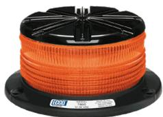
La baliza LED compacta Profile™ Serie 7460 incorpora un diseño simple pero altamente efectivo y resistente que presenta un disipador de calor superior que permite retirar la brida cuando la unidad está montada en tubería. Ocho LED de 3 vatios y un reflector parabólico llaman la atención y obtienen una salida de luz SAE Clase I.
